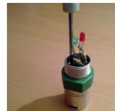
Étape 5 : Avant de réaliser le collage, il faut toujours vérifier que les contacts sont correctement en place, sinon la connexion à une autre fiche ne pourra pas s'effectuer, et le testeur sera inutilisable !
