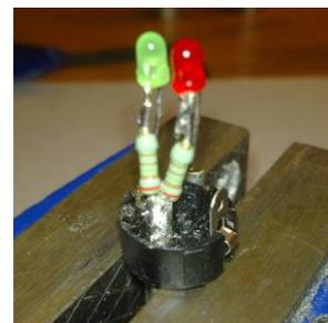
Étape 4 : Remonter l'assemblage effectué dans le corps de la fiche. Il faut bien faire attention à ne pas tordre les pattes des LEDs, et à ce que les pattes des composants **ne touchent pas le corps de la fiche** lors du remontage. Utiliser de préférence un tournevis plat pour pousser les contacts au fond.
